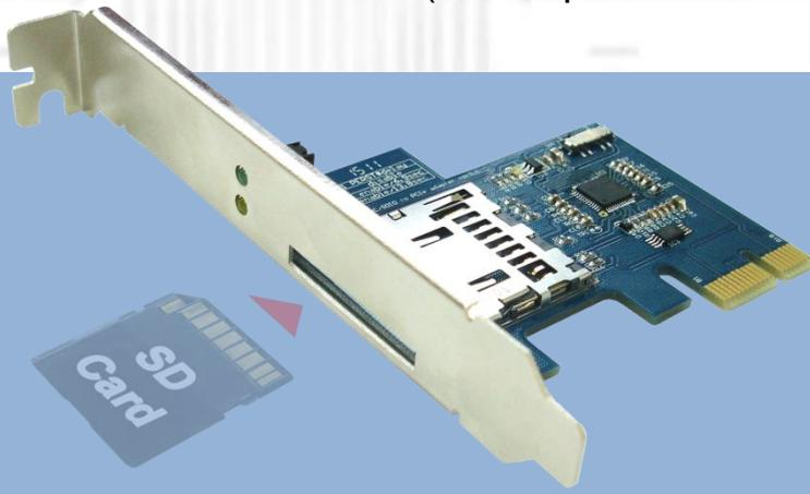
MP230はSD1.1 HighSpeed規格のSDHC/SDカードおよびSDIOカードに対応したSDカードリーダーです。
