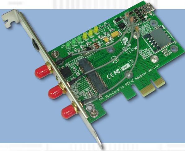
MP2AはMiniCardをPCI ExpressおよびUSB2.0に変換するアダプタです。PCIe スロットに装着してデスクトップ PC に内蔵してご利用いただけます。
