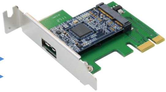
USB3380-AA EVK <-> PC (PCIe slot)
