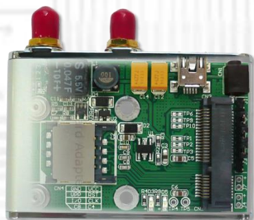
USBMI-D (無線通信 Mini Card 用 USB アダプタ ver1.1b) x1 IPX→RP-SMA メス変換 RF ケーブル: 2 本内蔵済
