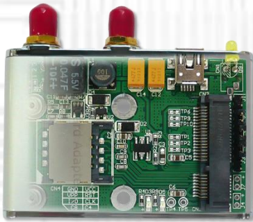
USBMI (無線通信 Mini Card 用 USB アダプタ ver1.1b) x1 IPX→RP-SMA メス変換 RF ケーブル: 2 本内蔵済
